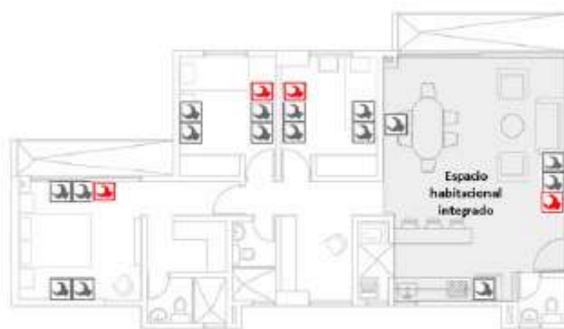
Ilustración 27. ubicación de las cajas de toma de ususario TDT en una vivienda hasta 280 SMMLV con el espacio habitacional de la cocina integrado con espacios de otros usos. Fuente: Propia.
