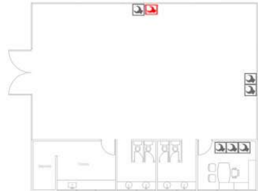
Ilustración 29. ubicación de las cajas de toma TDT en la zona común de una copropiedad. Fuente: Propia.
